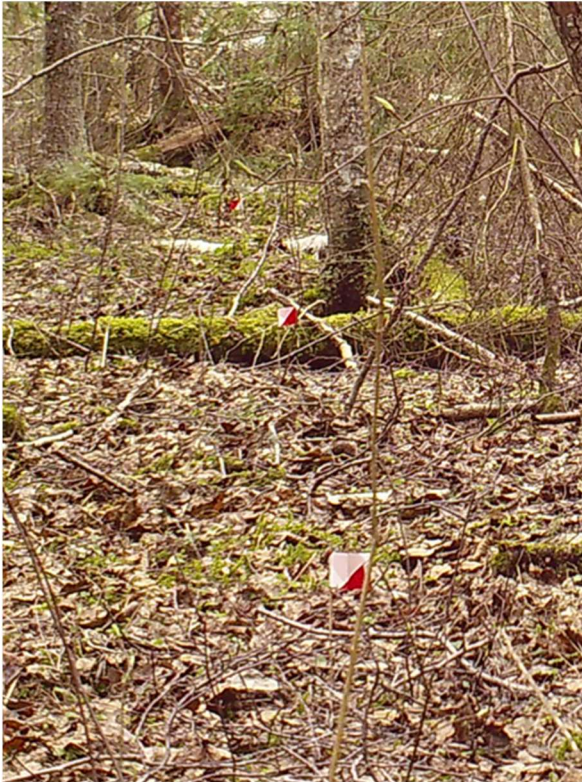
Fotod 1 ja 2. Kaamerast 5 m, 10 m ja 15 m kaugusele paigaldatud märgised (vasakpoolne foto) ja eksperimendis kasutatud rajakaamera Browning 2018 Dark Ops Pro XD (parempoolne foto).
