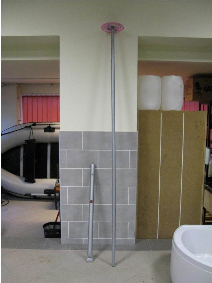
Foto 2. Koguja kate ja kinnitus. Vasakult paremale – maasse löödav metalltoru koos pitskruviga, puust vars koos roosa kattega
