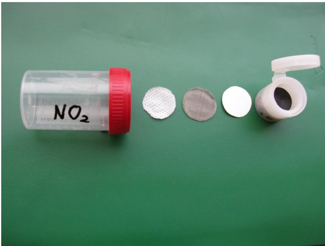
Foto 1. Koguja ehitus. Vasakult paremale - hoiutops, teflonmembraan, traatvõrk, keemiliste ühenditega immutatud filter ja ringikujulise avaga polüpropüleenist koguja korpus
